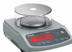
> Balanza ACCULAB (0 - 3kg , 0,1 g precisión)
