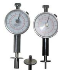
> Analizador de dureza (Esclerómetro para cereales/frutas)
