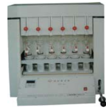
> Extractor de celulosa y fibra
