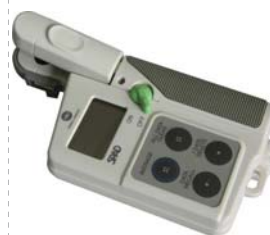
> Analizador de clorofila
